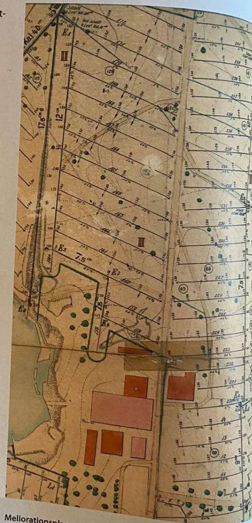
Meliorationsplan entlang Welsikerstrasse: Je nach Standort wurden bei den Drainagearbeiten im Abstand von acht bis zwölf Metern Drainagerohre verlegt.
